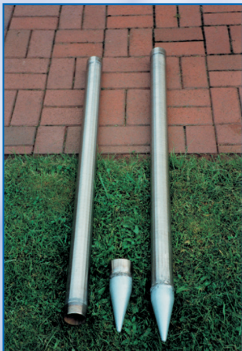
Система каркасно-стержневых фильтров для забивания
